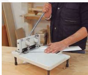
Corte de gran precisión. Con pisor automático.
