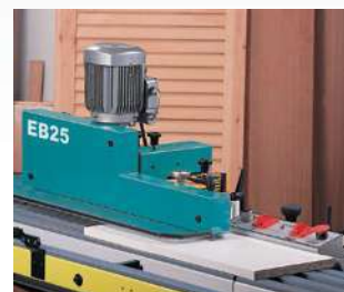
Grupo alimentador: Alimentación de la pieza a cantear.
