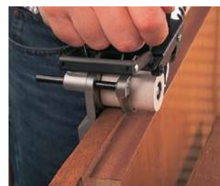
Aplacado de la cara superior del solape.
