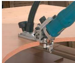
Palpador con rodamiento: guiado perfecto sobre superficies curvas o rectas.
