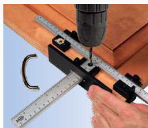
Taladrado para tiradores de puertas.
