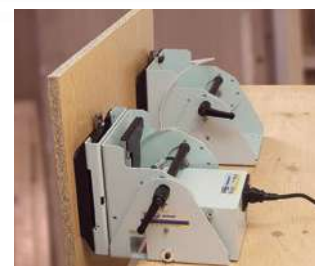
Sujetar piezas grandes con ayuda de una unidad auxiliar SVE680.
