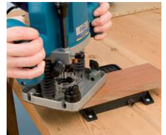
Sujeción de piezas pequeñas sobre una porción dividida del plato de succión.
