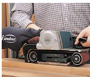
Mod. LB31EA con aspirador del polvo incorporado.
