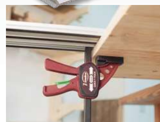
Incluye 2 sargentos que colocados en la gu a inferior sujetan el riel incluso cuando este sobresalga del panel.
