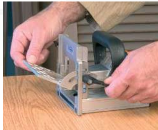
Frontal regulable en ngulo y altura con escalas graduadas.
