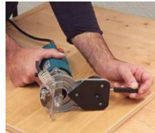
Dispositivo de guiado para el perfilado de esquinas alojado en la base cuando no se usa. Su colocaci n es muy r pida y sencilla.
