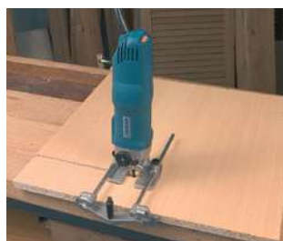
Fresado de regatas paralelas con gu a lateral.
