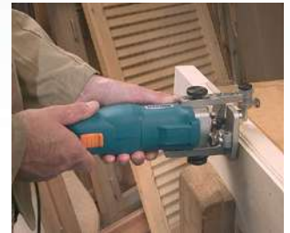
Realizaci n de molduras.
