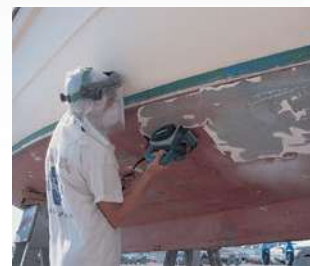
Trabajos de mantenimiento en astilleros.
