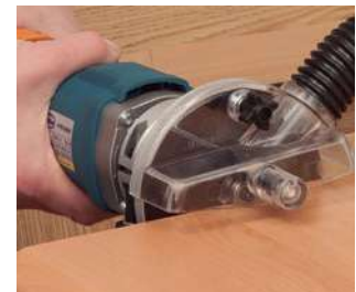
Cabezal redondo V3 incluido en el equipo. Muy pr ctico para perfilar con apoyo sobre el canto e imprescindible para los trabajos que as lo requieren.
