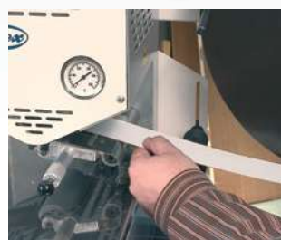
Pre-encolado de tiras sueltas.
