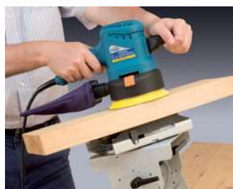
Soporte abatible y giratorio regulable.
