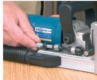
Ajuste r pido para las distintas profundidades de fresado.
