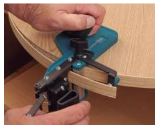
Retestado del sobrante en paneles circulares.
