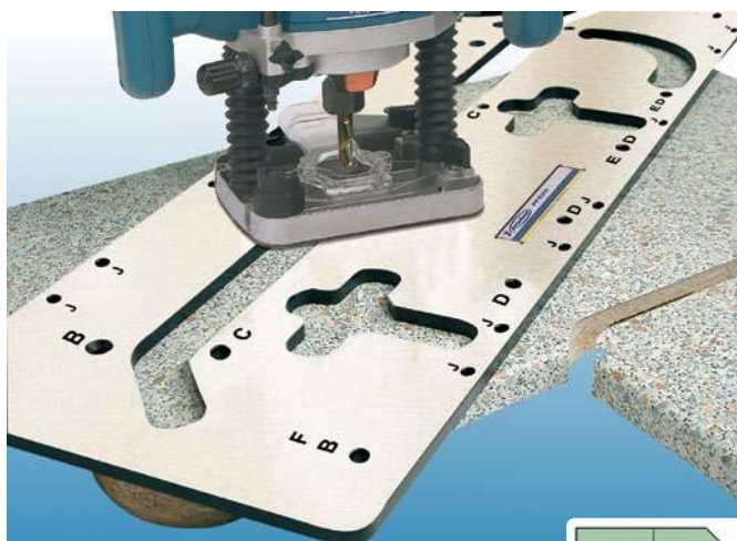
Fresado cruciforme para la uni n de las dos partes de la encimera.
