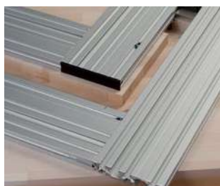
Equipada con accesorio para encajes rectos (sin radio), evitando el posterior relleno con masilla.
